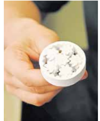
Dieses von einem amerikanischen Ingenieur entwickelte Lager lässt sich nur mit einem 3-D-Drucker herstellen.
